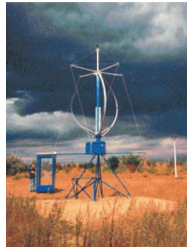
Es wurden verschiedene Design-Überlegungen angestellt. Ausgehend von einem runden Gehäuse fiel aus fertigungstechnischen Gründen die Entscheidung für ein kastenförmiges Gehäuse. Die Gruppe nahm Freifeldmessungen an einem Darrieus-Windgenerator in Petzow (Werder) an den Wochenenden vor. Dabei zeigten sich große Probleme bei der Kraftübertragung vom Rotor zum Generator durch einen zu schwach dimensionierten Keilriemen, der zusätzlich noch hohe Verluste aufwies.
